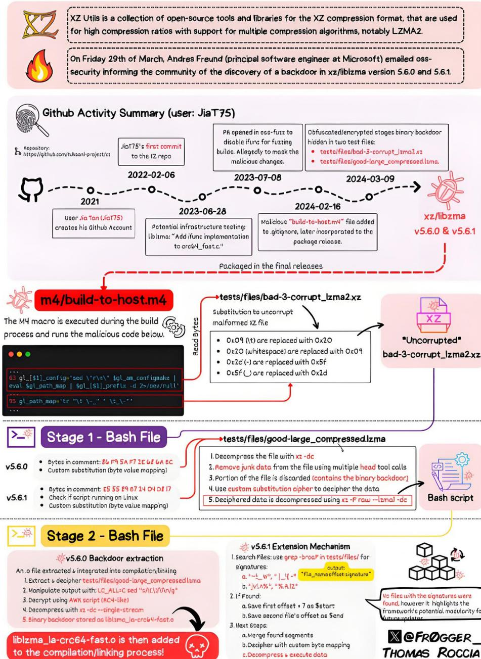
▲ 图 4.4 CVE-2024-3094 供应链攻击流程图
